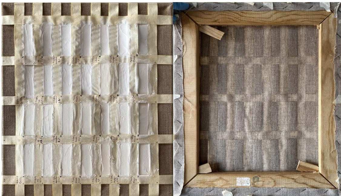
Fig. 18 Anvers i revers del bastidor en sortir de l'estufa amb temperatura elevada (Fotografies: Laura Romani)
