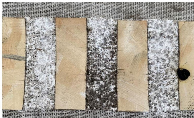
Fig. 2 Estucs sobre un suport de tela exposat a la intempèrie, on s'observa una important afectació fúngica (Fotografia: Laura Romani).
