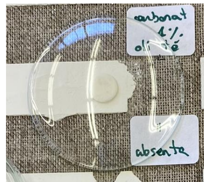
Fig. 44 Disc de cel·lulosa impregnat d'oli essencial de te al 15% a sobre de l'estuc de \text{CaCO}_3 amb 1% d'oli de te (Fotografia: Laura Romani)
