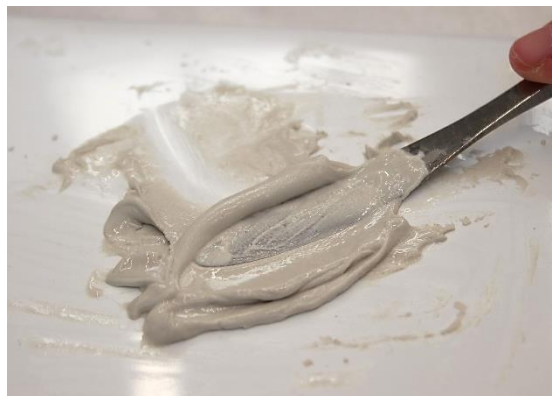
Fig. 1 Elaboració d'un estuc de cola de conill amb sulfat càlcic (Fotografia: Laura Romani)
