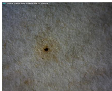
Fig. 10: Observació macroscòpica (50x) amb llum rasant de la partícula.
