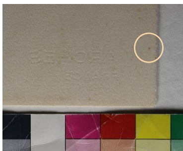
Fig. 9: Localització de la partícula metàl·lica de la litografia Salvador Espriu II.
