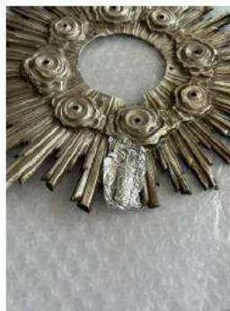
Fig. 28: prueba de limpieza electroquímica con la solución gelificada. Autora: Marta Gómez
