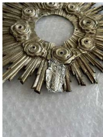
Figura 52. Prueba de limpieza electroquímica con la solución gelificada. (Fotografía: Marta Gómez Sanabri)
