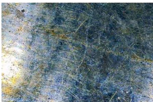
Figura 22. Fotografía con Dino-Lite® donde se observa la corrosión de la plata y las ralladuras por acción mecánica. (Fotografía: Marta Gómez Sanabria)
