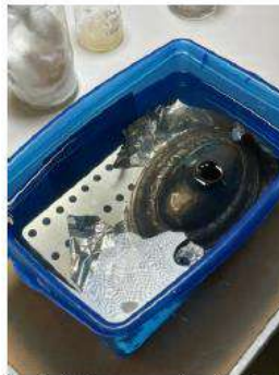
Fig. 27: limpieza electroquímica de la base con plancha de aluminio. Autora: Marta Gómez Sanabria.
