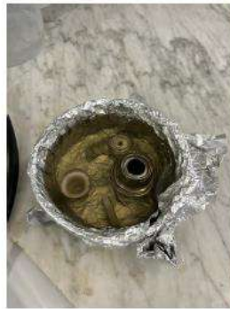
Fig. 26: las piezas después de 5 horas en el baño electroquímico. Autora: Marta Gómez Sanabria.
