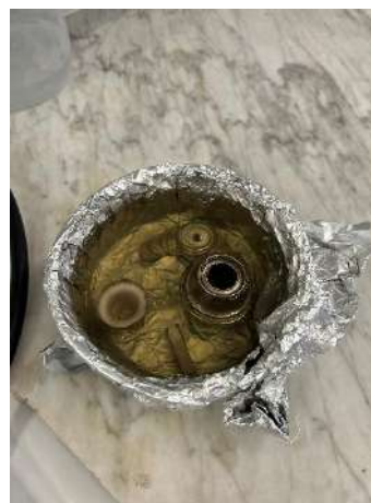
Figura 50. Las piezas después de 5 horas en el baño electroquímico. (Fotografía: Marta Gómez Sanabria)
