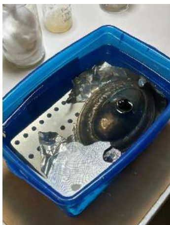
Figura 51. Limpieza electroquímica del pie con plancha Quicksilver®. (Fotografía: Marta Gómez Sanabria)
